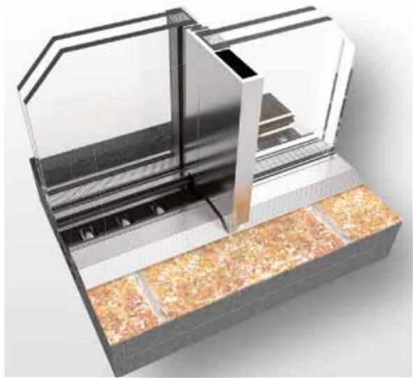
Particolari relativi rispettivamente al nodo laterale e centrale con telaio interamente incorporato alla muratura perimetrale, al fine di garantire la più completa riduzione di ostacoli visibili per l'ottenimento di ambienti più luminosi.
