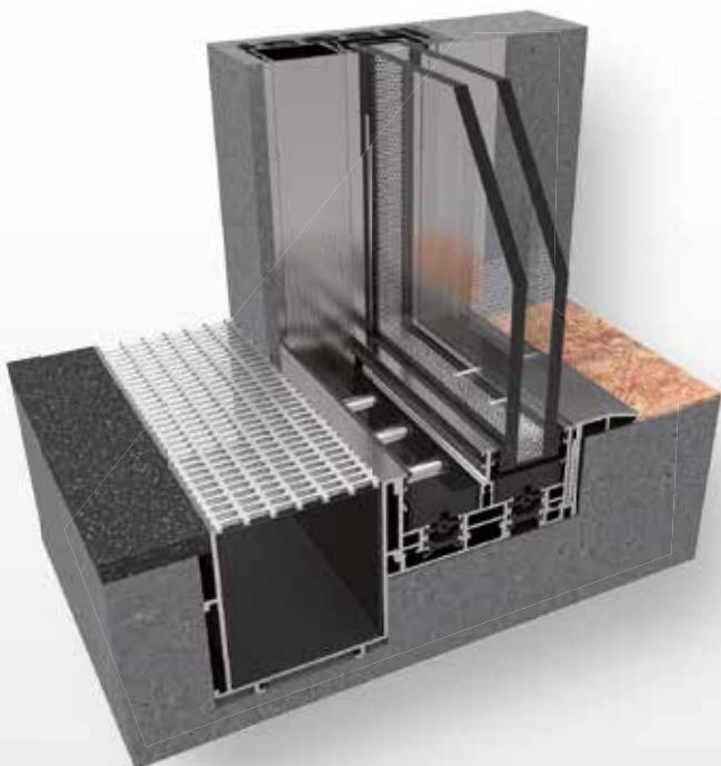
Particolari dei nodi laterali (viste interne ed esterne) con telaio integrato interamente nella muratura, con relativa griglia e sistema di raccolta per lo smaltimento delle acque meteoriche.
